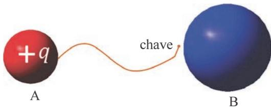
A figura acima ilustra duas esferas condutoras, A e B, inicialmente desconectadas e cujos raios satisfazem a relação  $R_B = 2R_A$ . A carga elétrica da esfera A (raio  $R_A$ ) é equivalente à carga de 90 elétrons, e a carga elétrica da esfera B (raio  $R_B$ ) é nula. Ao se ligar a chave, as duas esferas conectam-se por meio de um fio condutor elétrico, e o arranjo de cargas atinge o equilíbrio eletrostático.
