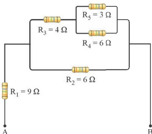
Considerando a figura acima, que ilustra um circuito constituído de resistores ligados em série e em paralelo, faça o que se pede no item a seguir, que é do **tipo B**.
